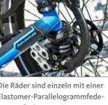
Die Räder sind einzeln mit einer Elastomer-Parallelogrammfederung aufgehängt.
