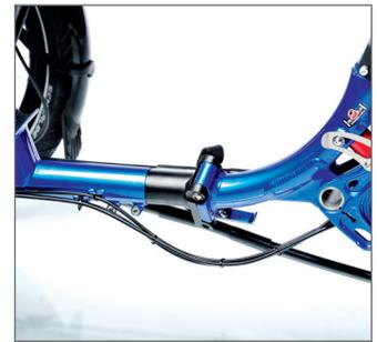
Komplexer Hinterbau: austauschbar, faltbar und gefedert.
