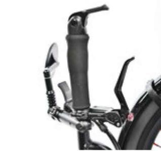
Alles im sportlichen Griff: Bremse, Schaltung, Feststellbremse.
